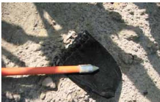
Extrémité de la sonde pénétrométrique
