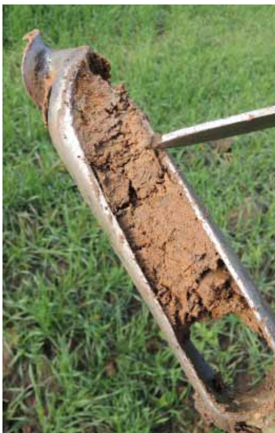
A l'aide d'un couteau, décapez la carotte prélevée pour bien observer le sol notamment la couleur.
