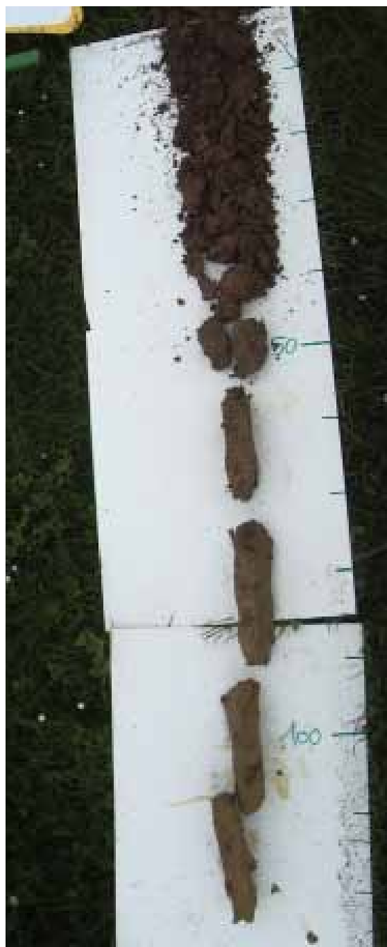
L'observation à l'aide d'une tarière permet de mettre en évidence des successions très différentes d'horizons.
